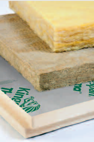
▲ Die am häufigsten eingesetzten Dämmstoffe sind: Glaswolle, Steinwolle und Polyurethandämmung.
