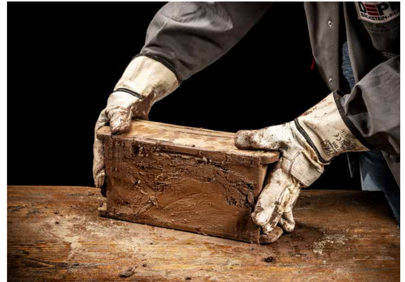
Ganz so wie früher läuft die Herstellung der Handformsteine bei uns nicht mehr ab, aber das Prinzip bleibt unverändert: Feuchter Ton wird in besandete Formen gedrückt. Der fertige Backstein wirkt wie von Hand geformt.
